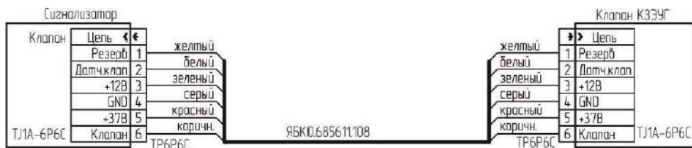
Рисунок В.2 – Схема подключения клапана КЗЭУГ с разъемом TJ1A-6P6C
